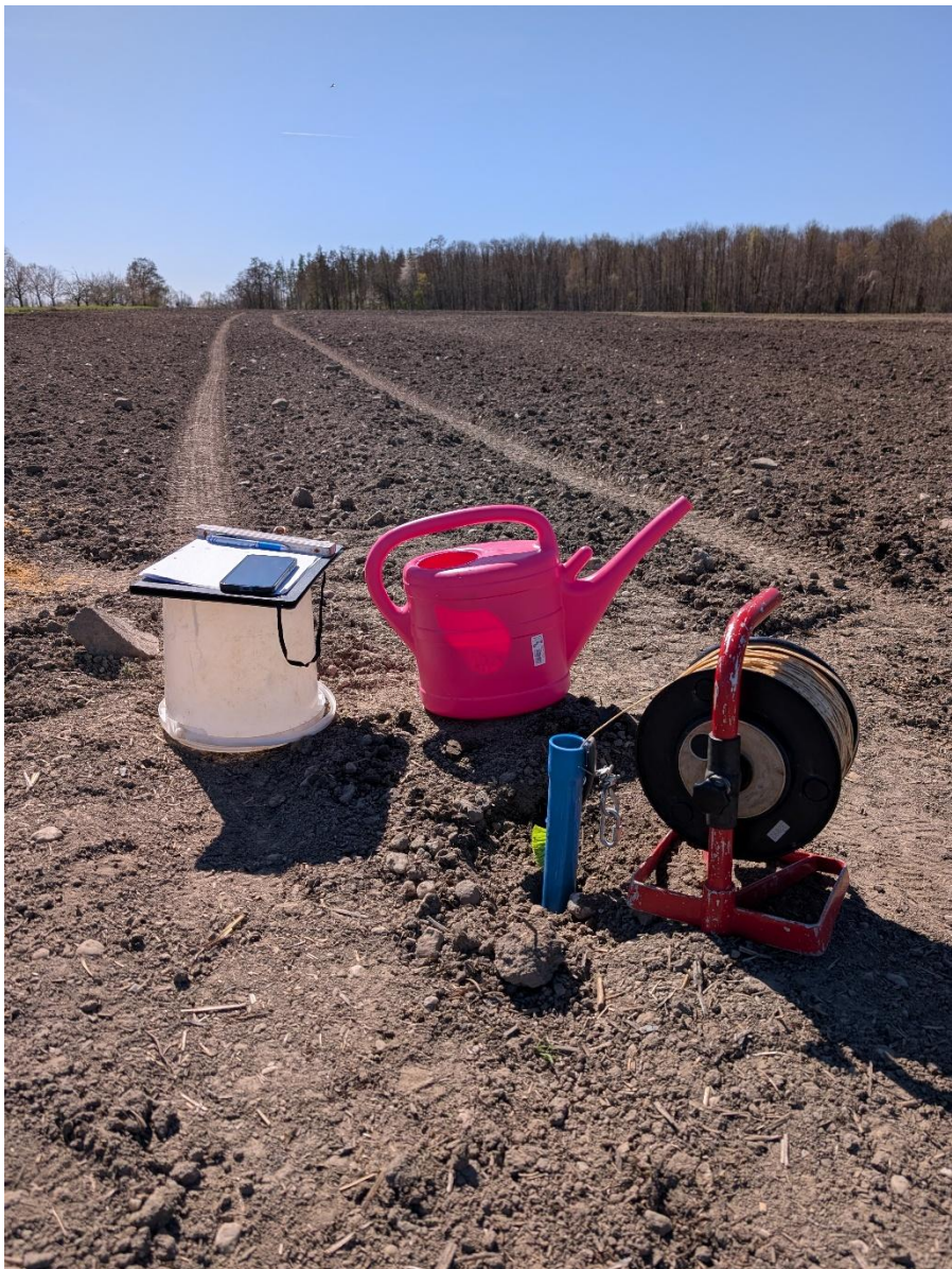
Abbildung 7: Beispiel Versuchsaufbau Versickerungsversuch
