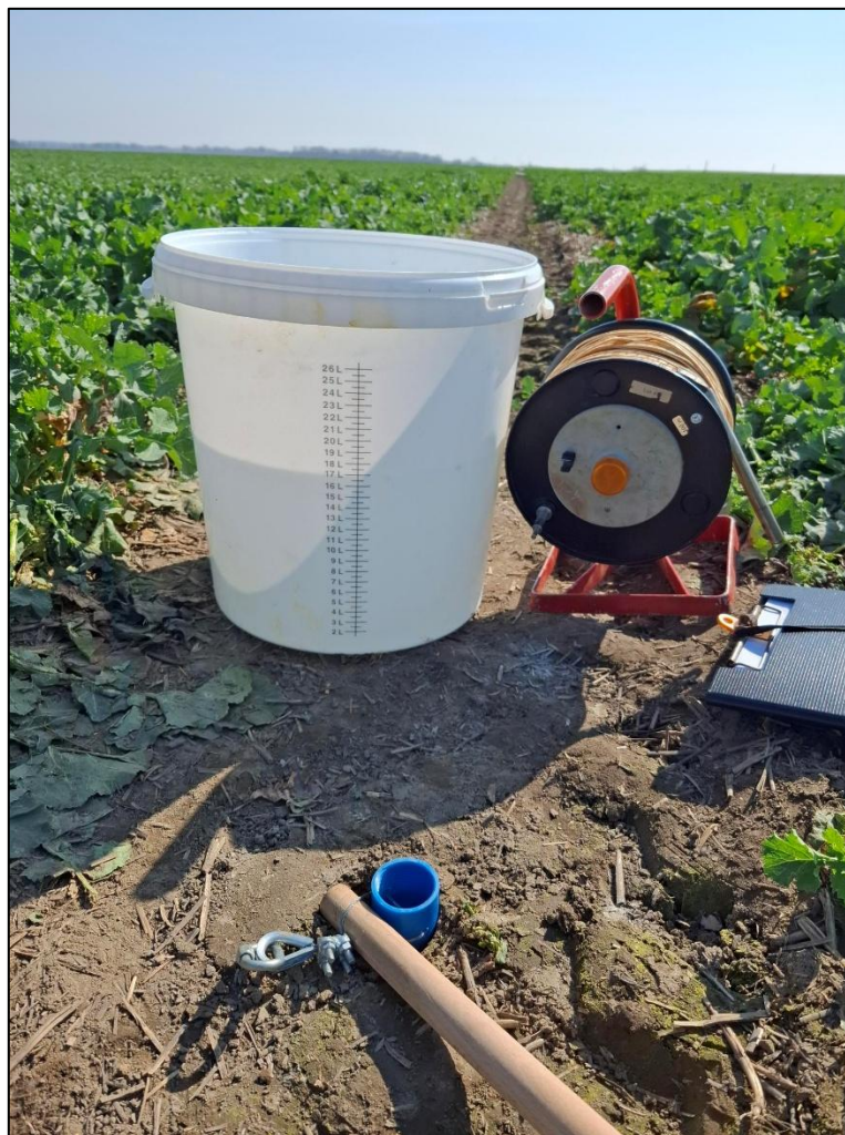
Abbildung 7: Beispiel Versuchsaufbau Versickerungsversuch (Ansatz
