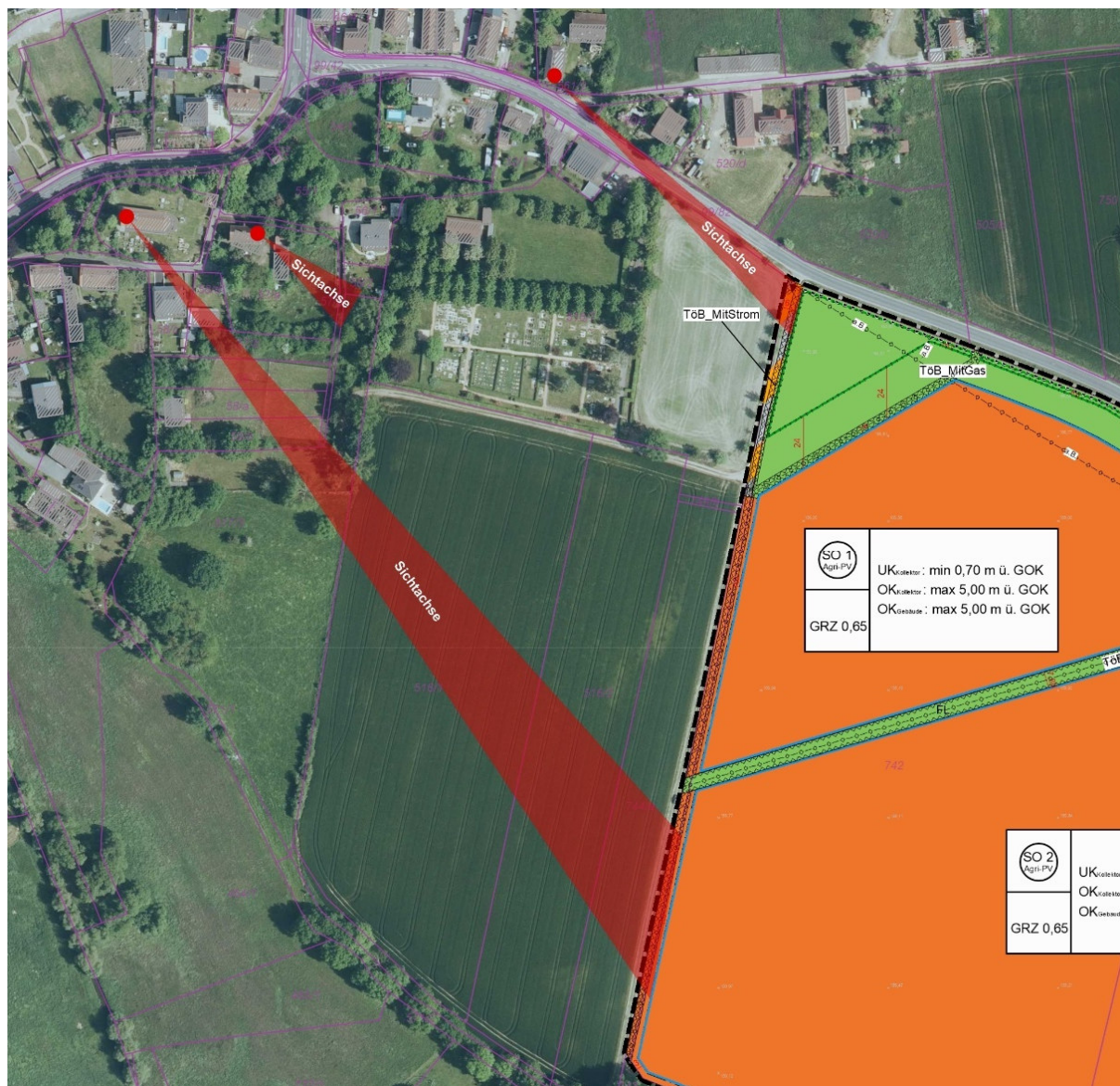
Abbildung 9 Sichtbeziehung zw. Baudenkmal und Projektfläche
