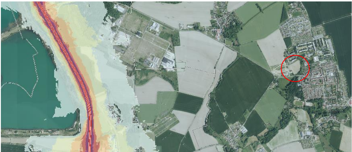
Abbildung 17: Hintergrund Lärmbelastung der A 72 im Bereich des Plangebietes (Lärmkartierung 2022, LUIS, Abfrage Januar 2025)
