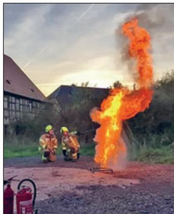
Löschversuch eines Ölbrandes zu Aufklärungszwecken mit Wasser
